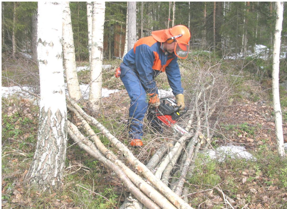
Kuva 8. Pitkät puut voidaan katkaista irrottamatta kahvaa sahasta.
