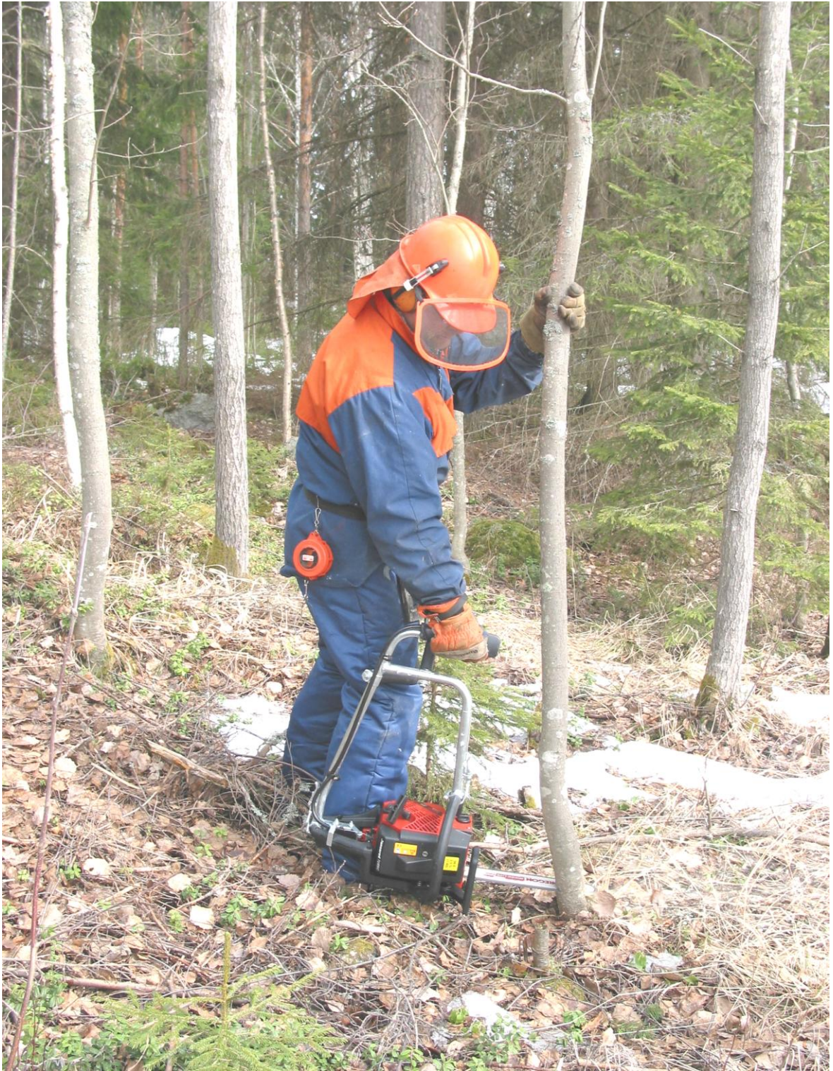
Kuva 9. Työasento kaatuvaa puuta vasemmalla kädellä ohjaten.
