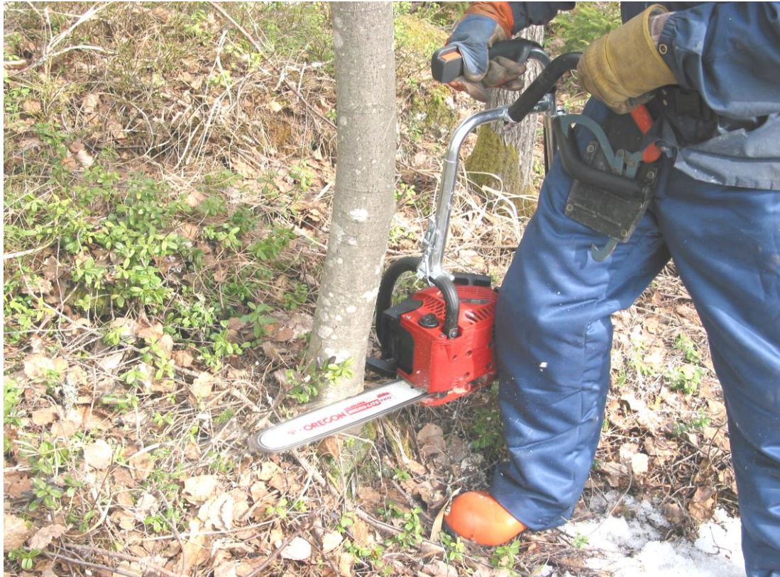
Kuva 7. Kaadettaessa pyritään käyttämään aina työntävää terää.
